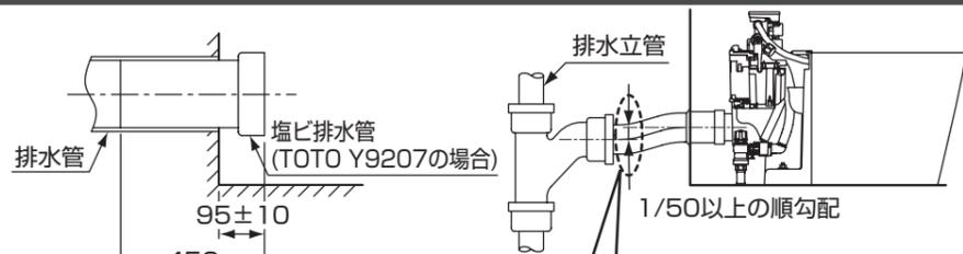
排水管サドル・支持金具・バンドなどで固定する場合は、便器排水口が接続できる高さに調整したあとに実施ください。固定の際は高さ調整した排水管を引っ張ったり、突き上げたりしないように注意ください。
