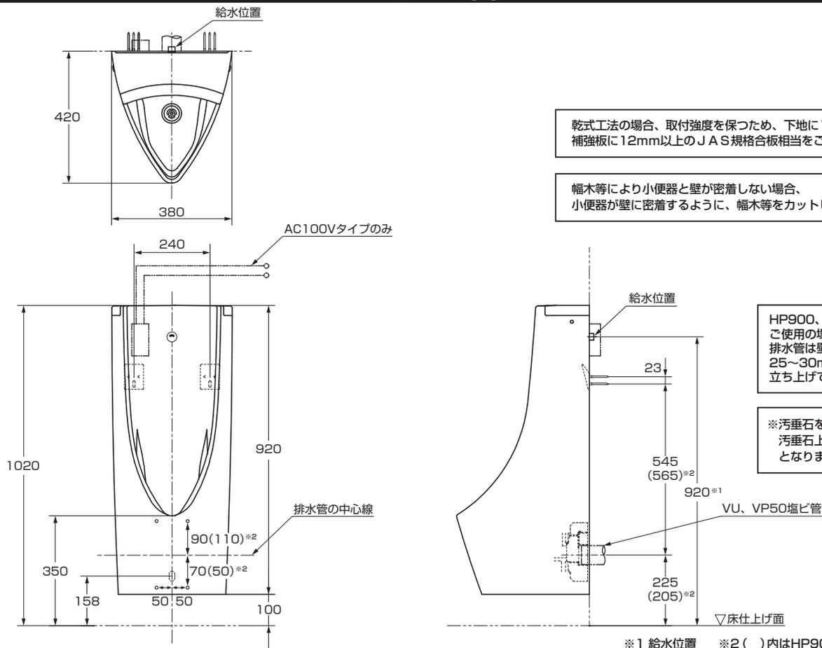
乾式工法の場合、取付強度を保つため、下地に12mm以上、補強板に12mm以上のJAS規格合板相当をご使用ください。
