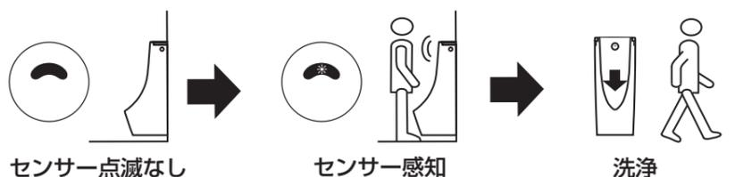
※人体感知のない状態で光電センサーが点灯しているときは、光電センサーが感知距離の自動調整を行っています。ランプの点灯が消えるまでお待ちください。(詳細は「11 光電センサー感知距離調整」をご確認ください)
