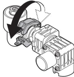
クイックファスナーカバーを確実にロックして固定する。
