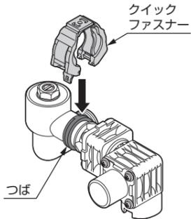
クイックファスナーを回転させ接続状態を確認する。
