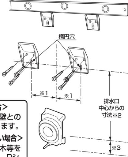
**注意** <小便器が所定の高さにつかない場合> バックハンガーの木ねじを緩め、壁との間に金属片を挟んで高さを調整します。
