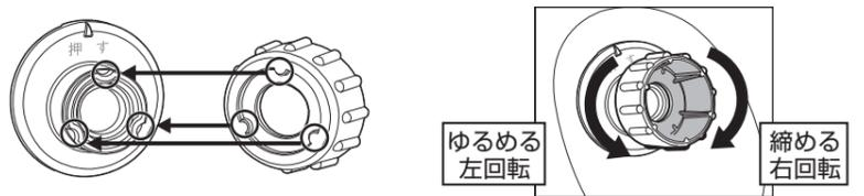
③掃除口ユニットの“押す”を押ししたまま、締付工具で締め付ける。
