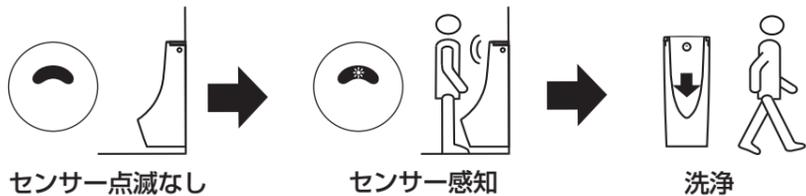
※人体感知のない状態で光電センサーが点灯しているときは、光電センサーが感知距離の自動調整を行っています。ランプの点灯が消えるまでお待ちください。(詳細は「12 光電センサー感知距離調整」をご確認ください)
