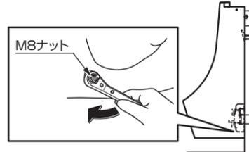
※ナットの対辺は13mmです。ナット締め付けには全長150mm以下の板ラチェットレンチを推奨します。
