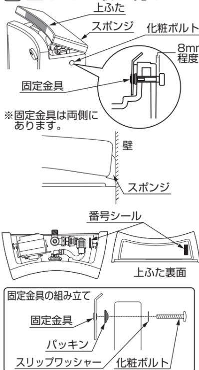
①固定金具を小便器内側から押さえ、六角棒レンチ(呼び4)で化粧ボルトをゆるめる。
