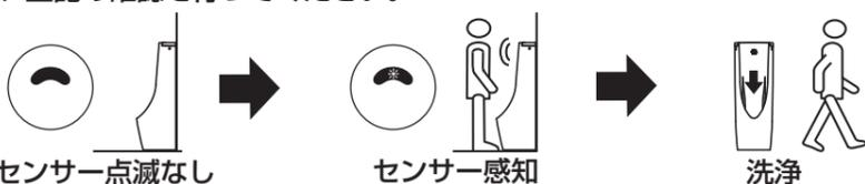
※人体感知のない状態で光電センサーが点灯しているときは、光電センサーが感知距離の自動調整を行っています。ランプの点灯が消えるまでお待ちください。(詳細は「10 光電センサー感知距離調整」をご確認ください)
