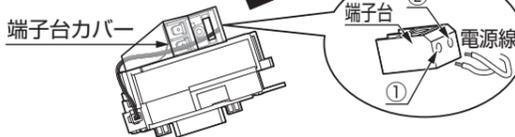
スイッチボックスから電源線を取り出し防水カバーの後ろを通し、端子2つ(①と②)に接続する。
