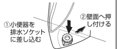
③小便器後面を壁面につけた状態で木ねじを固定金具穴から固定片にねじ込み、小便器を固定する。
