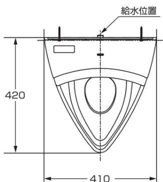
乾式工法の場合、取付強度を保つため、下地に12mm以上、補強板に12mm以上のJAS規格合板相当をご使用ください。
