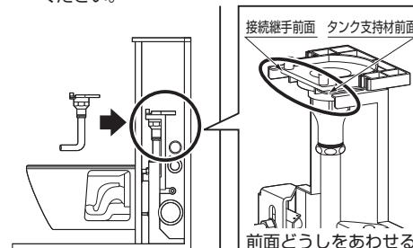
④洗浄管とスパッドを連結させ、袋ナットで締め付ける。
