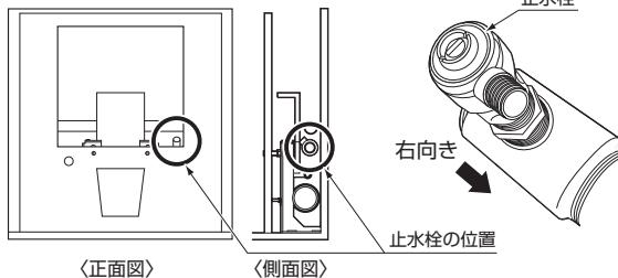
確認：止水栓は斜め上方向に壁から約45°立ち上げて、接続方向は向かって右向き。
