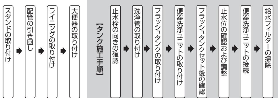
壁掛大便器以外の器具に関しては、各器具に同梱の施工説明書を参照して、取り付けを完了してください。
