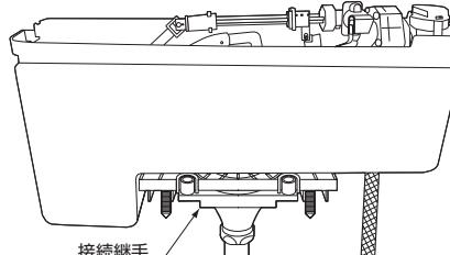
下図のようにフラッシュタンクを奥へスライドさせ、真っすぐ下ろすように接続継手に取り付けると確実にシールできます。
