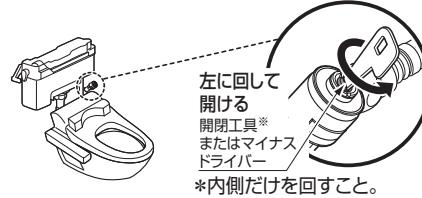
(2) ボールタップを回し、止水位を標準位置に確實にあわせる。
