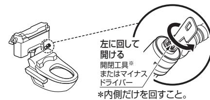
(2) ポールタップを回し、止水位を凸部上端に確実にあわせる。
