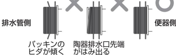
排水ソケットの高さ、排水ソケット口径の陶器公差・排水管の高さの施工誤差によっては、パッキンがはみ出すことがあります。
