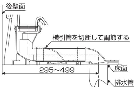
商品セット図 (施工完了図) 壁給水タイプ
