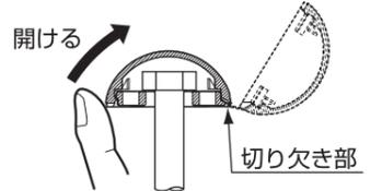
④-2 木ねじを取り付けたあと、化粧キャップを矢印の方向に「パチッ」と音がするまで押し込む。
