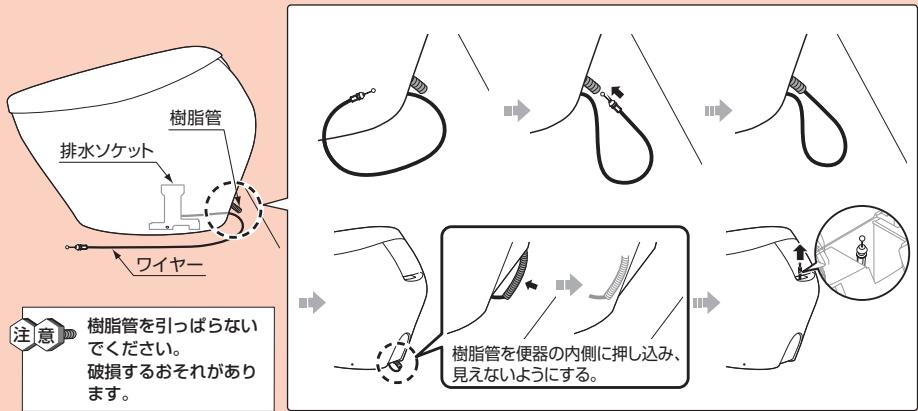
②-1 ワイヤー先端のボールをつまみ出し、カバーのスリットにワイヤーと手動レバーを引っ掛ける。
