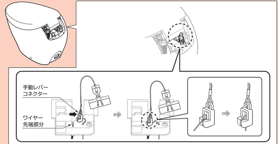
④手動レバーを上引き上げ、コネクターがはずれないか確認し、カバー内に収納する。
