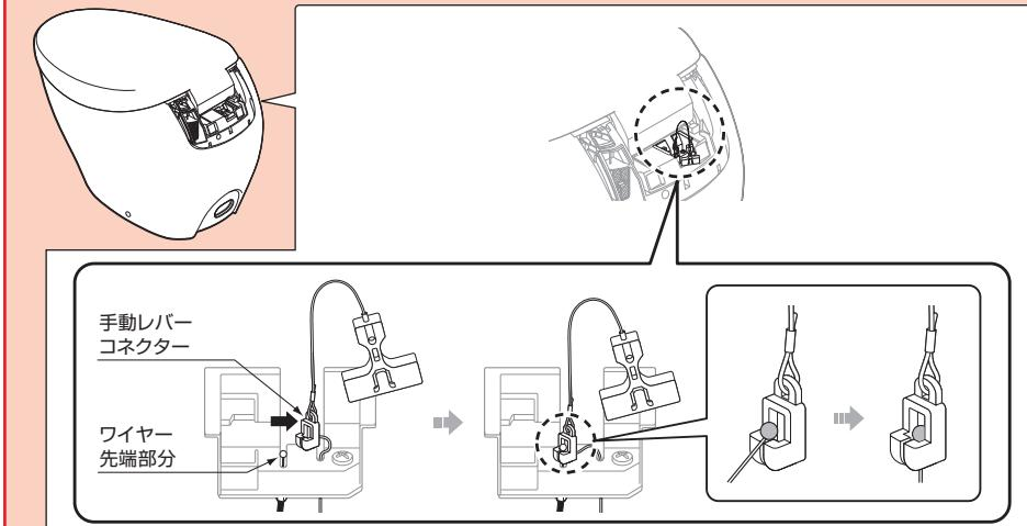
④手動レバーを上に引き上げ、コネクターがはずれないか確認し、カバー内に収納する。
