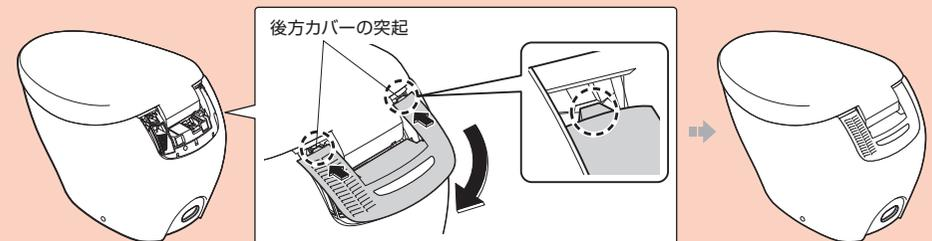
突起は確実に差し込んでください。(後方カバーの破損の原因)
