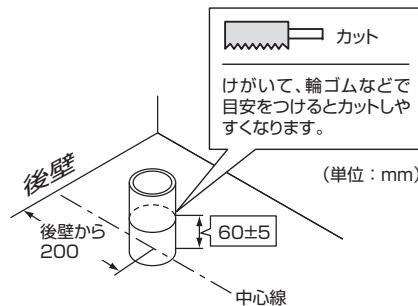
※排水管の切断面のバリ、汚れは必ず除去してください。
