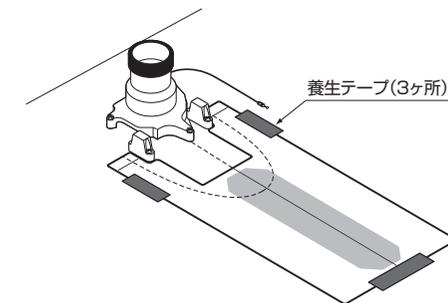
**注意** 養生テープは上図のように傷防止シートの外側に貼り付けてください。内側に貼り付けると、便器取り付け後に傷防止シートを取り外すことができません。
