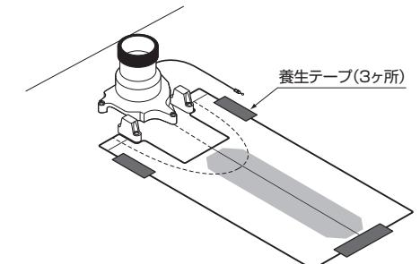
**注意** 養生テープは上図のように傷防止シートの外側に貼り付けてください。
