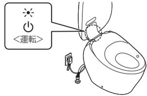
●試運転の前および試運転完了時は、必ず電源プラグがコンセントに差し込まれていることを確認してください。
