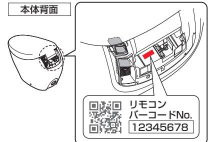
本体とリモコンのNo.(8桁)で、組み合わせを確認してください。
