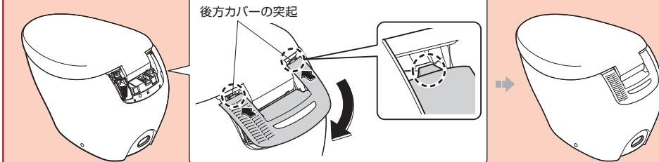
後方カバーを取り付けた際、浮いているときはカバーを取り付けなおしてください。
