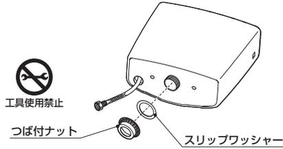
⑥ 陶器タンク外側から取付ボルトを通し、締め込む。
