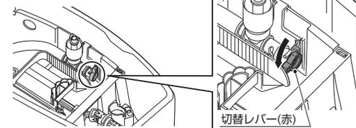
④ボールタップの浮玉取付位置を下段の凹部に変更する。
