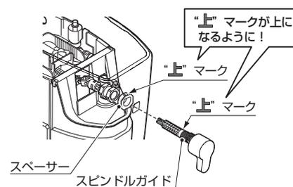
④スピンドルガイドにナットをねじ込み、ナットを握って力強く手締めしたあと、工具で90°以上増し締める。
