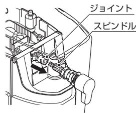
⑥ジョイント角穴にピンを「カチッ」と音がするまで差し込み、固定する。
