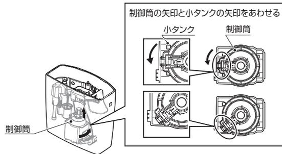
**注意** 制御筒の取り外し時に樹脂タンクに傷をつけないようにしてください。
