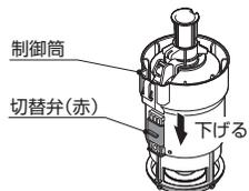
⑤制御筒を時計回りに回して取り付ける。
