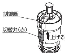
⑧制御筒を時計回りに回して取り付ける。
