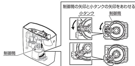
**注意** 制御筒の取り外し時に樹脂タンクに傷をつけないようにしてください。
