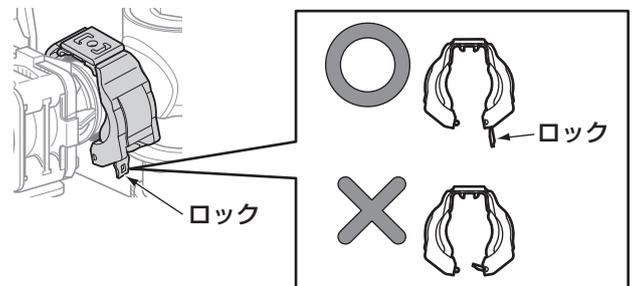
**3** カバーの左右を指で押さえて閉じ、ロックが見えるように手前に回し、クイックファスナーが閉じていることを確認する。
