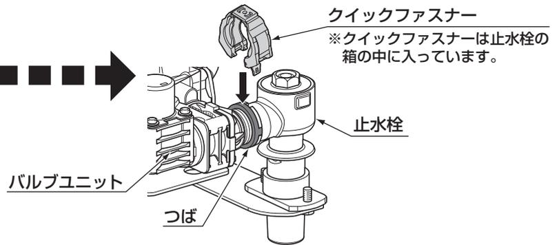
**1** 止水栓本体とバルブユニットのつばにクイックファスナーの凹部を合わせ、真っすぐに差し込んでください。
