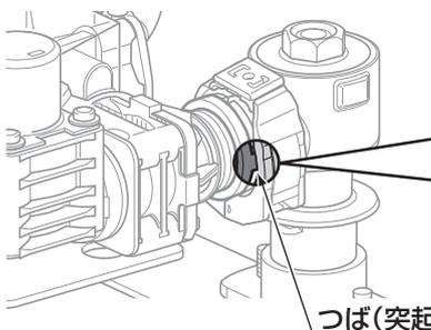
つば(突起部)が見えている場合は正しく取り付けられていません。クイックファスナーを外して、再度、止水栓とバルブユニットを取り付けてください。給水圧でつばが抜けて水漏れするおそれがあります。
