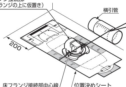
横引管を床フランジ接続部中心線と同じ目盛り位置で真っすぐに切断する。
