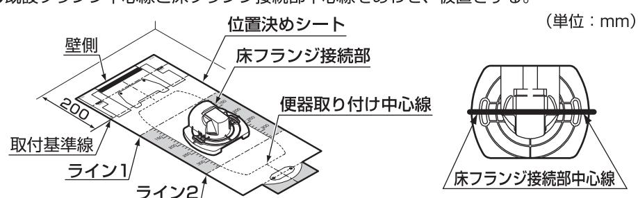
ケース1 床フランジ接続部中心線がライン1とライン2の間にある
