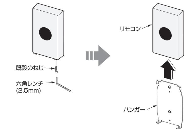
② 既設のリモコンまたは、購入したリモコン裏面の電池カバーを開ける。
