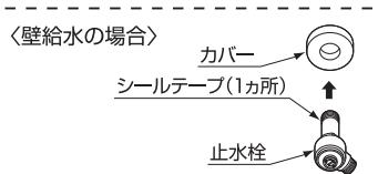
・ねじ部にはシールテープを巻いて取り付けてください。※取り付け時の際、止水栓の向きに気をつけてください。
