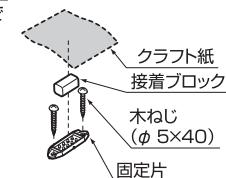
⑤接着ブロックを、クラフト紙に包んだ状態のまま固定片の凹部のピンに差し込み、指で軽く押す。
