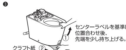
③便器の取付穴（2力所）をねじで固定し、化粧キャップを取り付ける。
