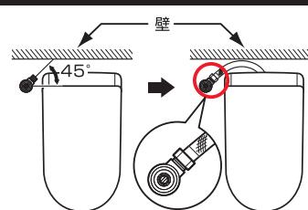
壁給水の場合の止水栓取り出し方向
