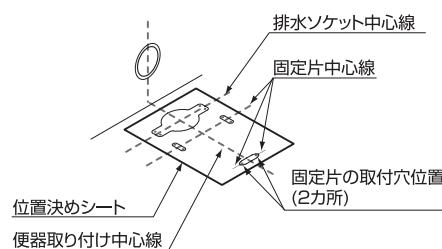
②固定片取付穴位置、固定片中心線をけがく。
