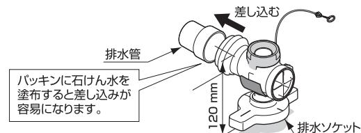
⑤排水ソケットが壁に平行になるように調整し、排水ソケット中心線をけがく。
