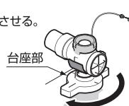
③排水ソケットが壁に平行になるように調整する。
