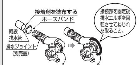
9 固定片・マルチ排水ソケットの取り付け
