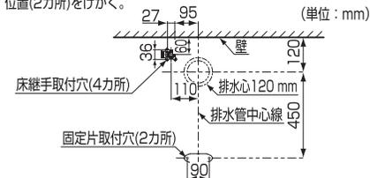
2 排水ソケットを仮置きし、排水ソケット取付穴位置(6カ所)をけがく。
