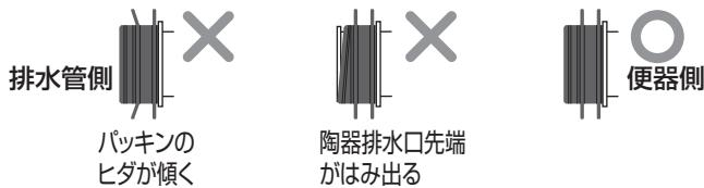
排水ソケットの高さ、排水ソケット口径の陶器公差・排水管の高さの施工誤差によっては、パッキンがはみ出しがあります。水溜試験の結果、水漏れしていなければパッキンがはみ出していても品質的に問題はございません。
