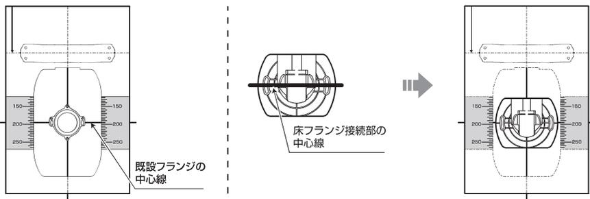
3 横引管の取付方法が床フランジ接続部の中心線の位置で異なるため、下図に従って床フランジ接続部の中心線の位置を確認する。
