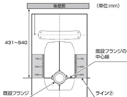
2 既設フランジと床フランジ接続部の中心線が合うように、床フランジ接続部を仮置きする。
