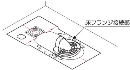
③ 床フランジ接続部中心線が指す、位置決めシートの目盛り位置と同じ目盛り位置で横引管を切断する。
