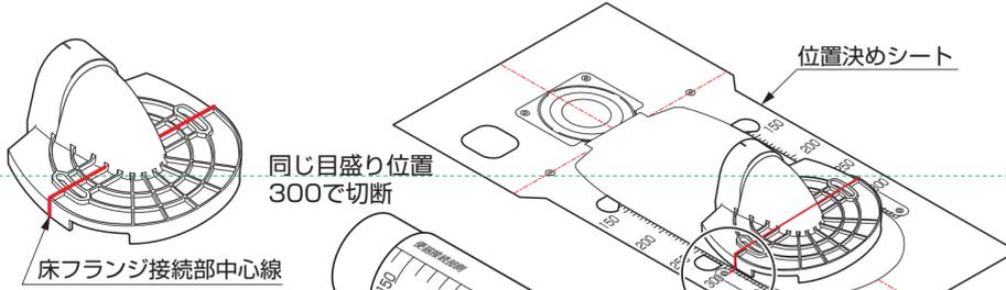
床フランジ接続部中心線が指した目盛り位置と、同じ目盛り位置で横引管を真っすぐに切断する。
