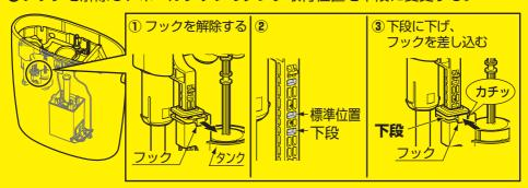
❺ボールタップの浮玉取付位置を、上段の凹部に変更する。
