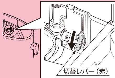
④ フックを解除し、ボールタップのタンク取付位置を下段に変更する。
