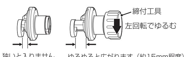
3 掃除口ユニットの“押す”を押したまま、締付工具で締め付ける。
