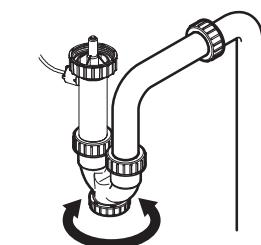
接続部分を回転させ、排水位置を調節してください。
