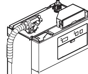
取り付ける前に**必ず給水・給湯管内のごみ、砂などを完全に洗い流す。**
