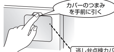
逃し弁点検カバー
