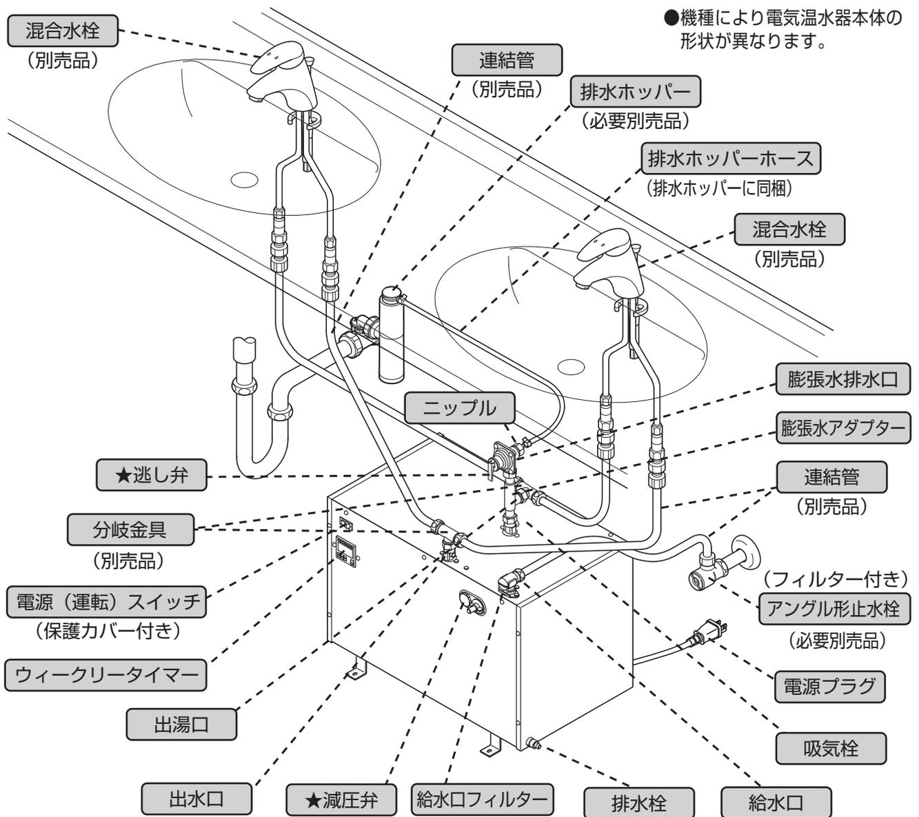
★減圧弁・逃し弁は消耗部品のため、定期的に交換してください。
