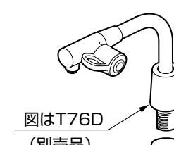
熱湯用単水栓(T76D)の取付穴径は、φ25mmです。
