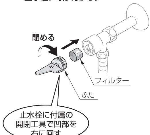
止水栓に付属の開閉工具で凹部を右に回す
