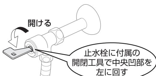
止水栓に付属の開閉工具で中央凹部を左に回す
