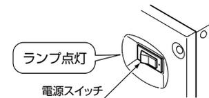
※沸き上がると自動温度調節器が作動し、電源スイッチのランプが消灯します。
