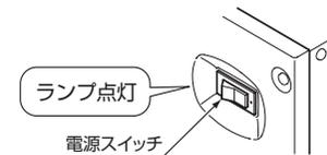
⑧沸き上がると自動温度調節器が作動し、電源スイッチのランプが消灯します。
