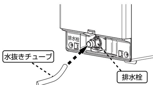
5 排水栓ツマミを左に回してタンク内の水を抜く。RE01Mについては水抜き時に吸気栓を取り外す。
