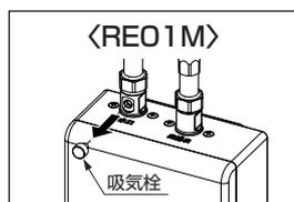
6 排水後、排水栓は水漏れがないようにしっかり閉める。RE01Mは吸気栓も取り付ける。
