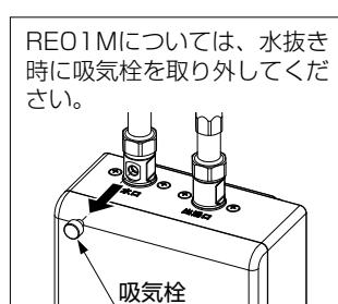
(6) 水抜き後は電気温水器の排水栓を閉じる。
