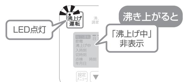
タンク内の湯の温度が下がると再び沸き上げを開始する
