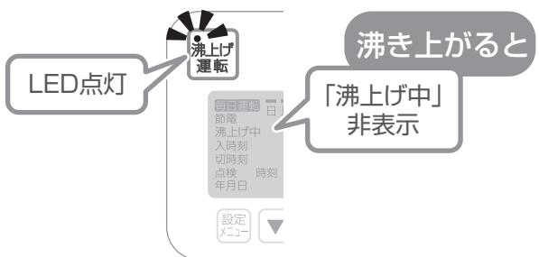
タンク内の湯の温度が下がると再び沸き上げを開始する
