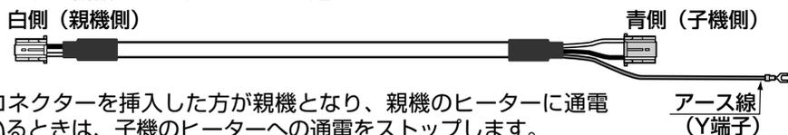
白のコネクターを挿入した方が親機となり、親機のヒーターに通電しているときは、子機のヒーターへの通電をストップします。
