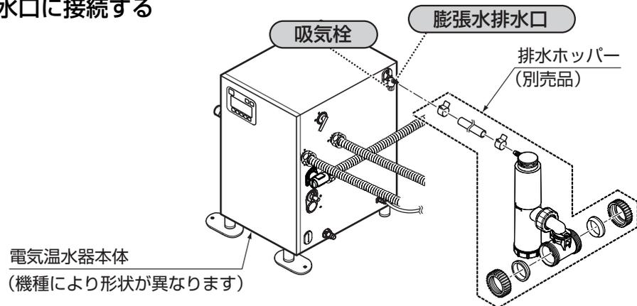
**注意** 排水ホッパーは必ず、電気温水器1台につき、1個取り付けてください。
