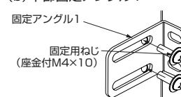
側面および下部の固定アングル1は、L字型の長い方を本体に取り付ける。
