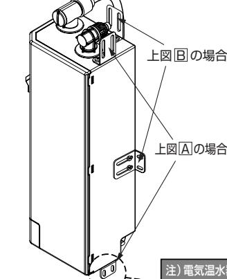
注) 電気温水器をキャビネット床に据え置きする手洗器の場合は、下部への固定アングル取り付けは不要です。
