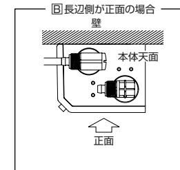
(1) 同梱の固定アングル2個を電気温水器本体に同梱のねじ4本で固定する。
