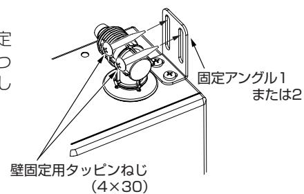
注) スペーサーが必要な手洗器については、スペーサーを固定用ねじ(2本)で電気温水器上部の固定アングル1に取り付けてください。
