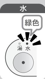
湯水切り替えスイッチ上のランプが点灯している側が出ます。湯水切り替えスイッチを押すとランプの点灯が切り替わり、湯と水が切り替わります。
