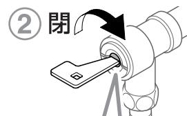
止水栓に付属の開閉工具で中央凹部を右に回す
