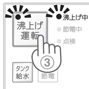
沸上げ中ランプが点滅、点検ランプが点灯している場合
