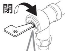
止水栓に付属の開閉工具で中央凹部を右に回す
