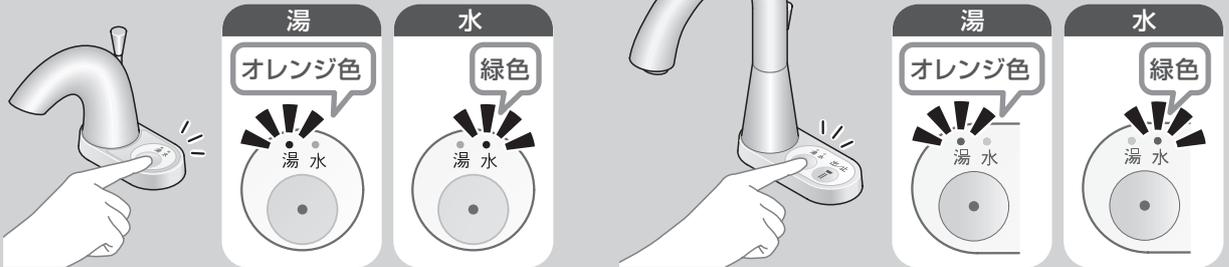
湯水切り替えスイッチ上のランプが点灯している側が出ます。湯水切り替えスイッチを押すとランプの点灯が切り替わり、湯と水が切り替わります。
