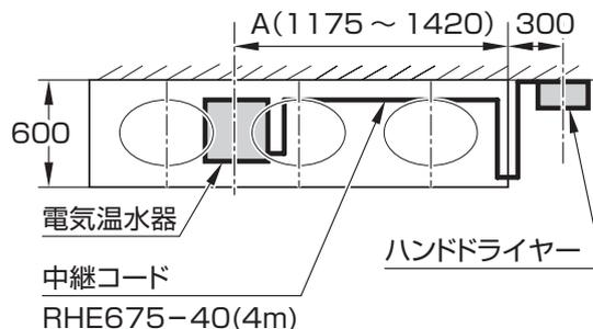
※上図はハンドドライヤーと電気温水器の距離が長くなる30Lの電気温水器を洗面器3連に設置した場合を表しています。
