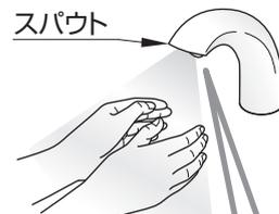
湯が出てくるまでセンサーを作動させる
