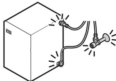
❗ 出る湯（水）の量が少なくなったら、止水栓のフィルターの点検・清掃を行う 10・11ページ
