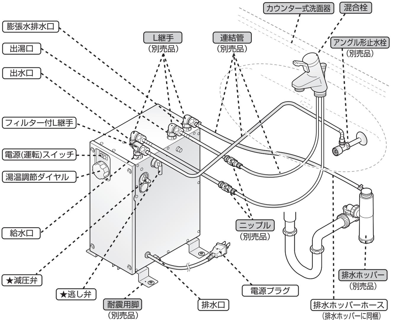
★減圧弁・逃し弁は消耗部品のため、定期的に交換してください。
