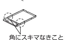
③キャビネットに漏水誘導シートを敷き、電気温水器本体を設置する。
