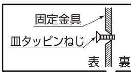
**注意** 電動ドライバーなどを使わずに、手締めをしてください。固定金具は表と裏を間違えないようにしてください。電源コードを傷つけないこと。
