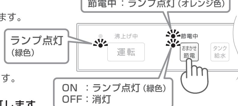
節電中は沸上げ温度が下がるため、スパウトから出る湯の温度が低くなります。
