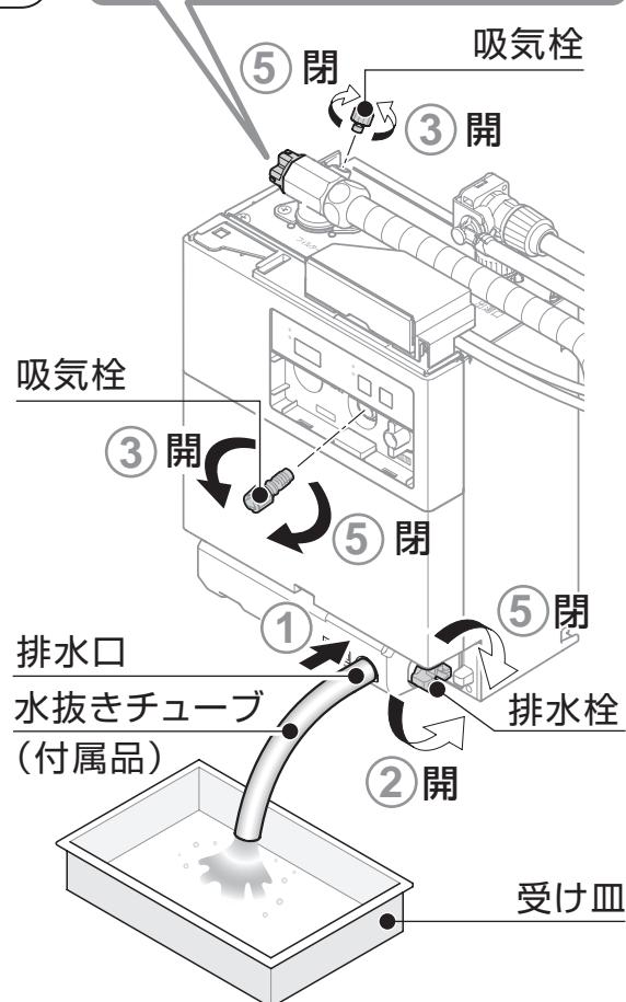
6 排水栓、吸気栓（2カ所）、給水口フィルターが閉まっていることを確認し、
