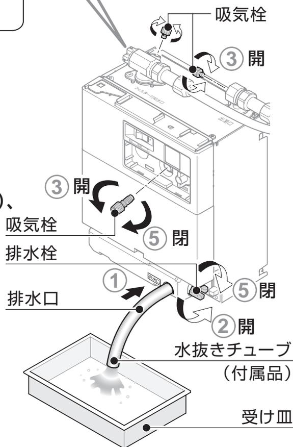
6 排水栓、吸気栓（3カ所）、給水口フィルターが閉まっていることを確認し、水抜きチューブを抜く
