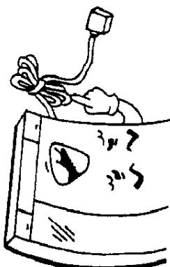
化粧鏡の移動、移設の際電気コードを傷つけないでください
