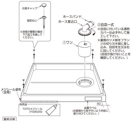
施工後、トラップ取り付け部、配管接続部の接続が正しくできたかの確認のために、水を張って水漏れがないかを点検してください。
