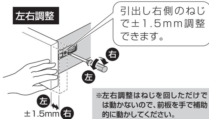
※左右調整はねじを回しただけでは動かないので、前板を手で補助的に動かしてください。
