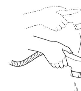
\*水抜き完了後は必ず水抜きコックを確実に閉めてください。
